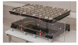
Прототип беспроводной системы состоит из приемника и передатчика. Приемник устанавливается на дно электромобиля еще на стадии заводской сборки, а передатчик размещается под дорожным покрытием. В процессе зарядки между ними формируется ближнее магнитное поле, необходимое для передачи энергии.
