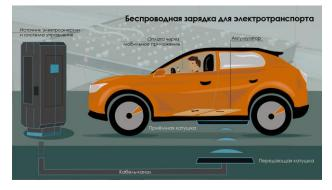
Аппарат мощностью 11 кВт заряжает автомобиль на расстоянии до 30 см. Эффективность такой зарядки достигает 95 % — это означает, что в процессе теряется лишь 5 % передаваемой энергии. В ближайшие полгода авторы работы планируют увеличить мощность аккумулятора до 50 кВт — в этом
