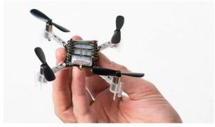
Как это работает: находясь в помещении, робот издает звуки на разных частотах, а установленный на нем микрофон — улавливает отраженное от стен эхо. Затем, после звукового анализа, специальный алгоритм составляет карту помещения с указанием его размеров и расположением препятствий.
